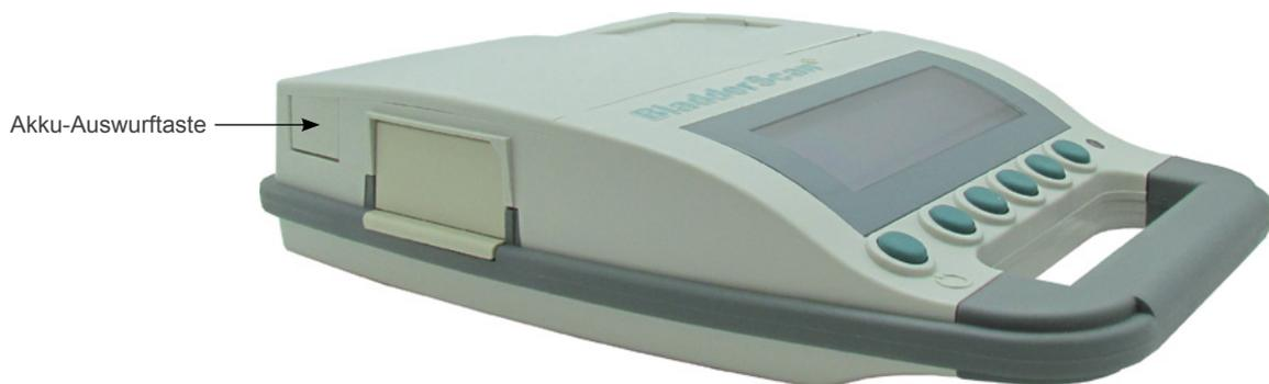
2. Schieben Sie den Akku aus der Steuereinheit.
