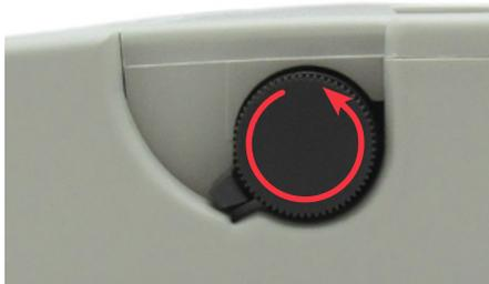
3. Drehen Sie den Verriegelungshebel des Druckkopfs so, dass er auf die 10-Uhr-Position zeigt.
