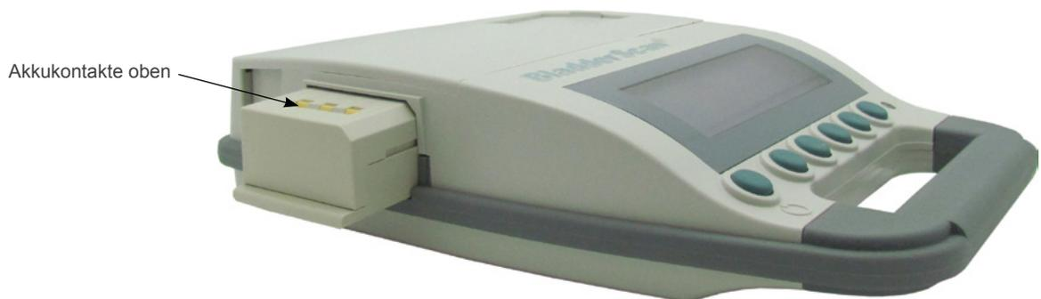
4. Schieben Sie den Akku in den Einschub und drücken Sie, bis der Akku einrastet.
