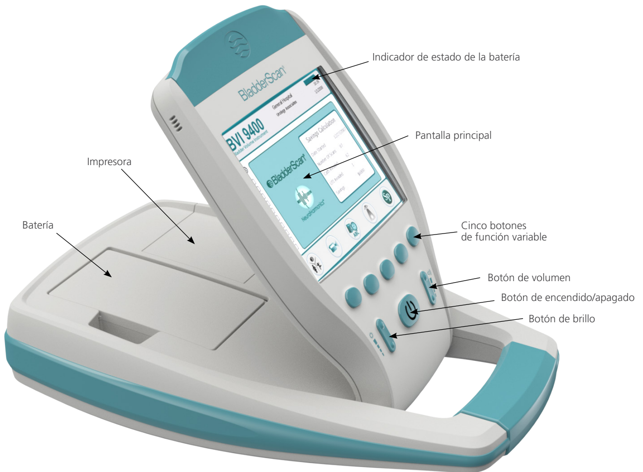
Figura 3. Componentes de la consola
