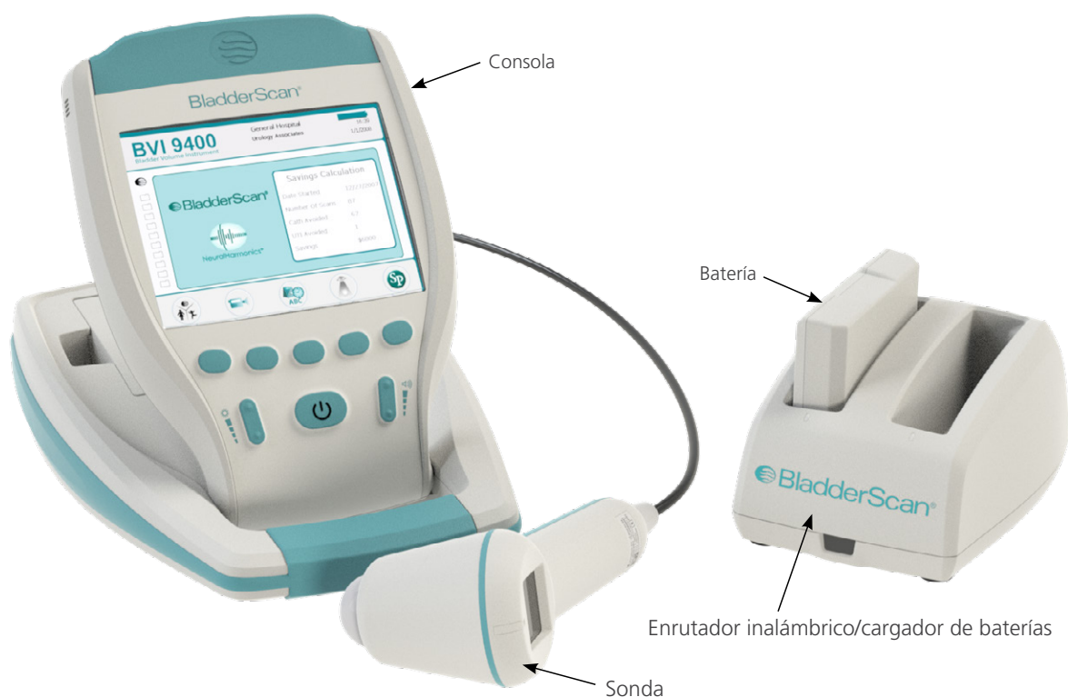
Figura 1. Componentes de BladderScan BVI 9400
