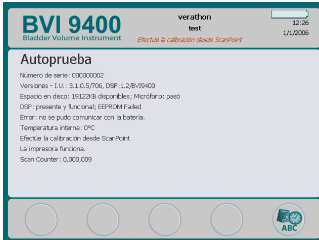
Figura 7. Pantalla de autoprueba e impresión cuando EEPROM falla
