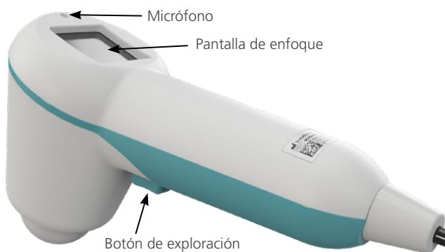
Figura 2. Componentes de la sonda
