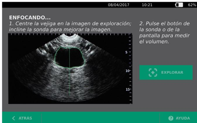
10. Cuando haya terminado de enfocar la sonda, pulse el botón de la sonda o toque **Explorar** en la pantalla. El proceso de exploración empieza.
