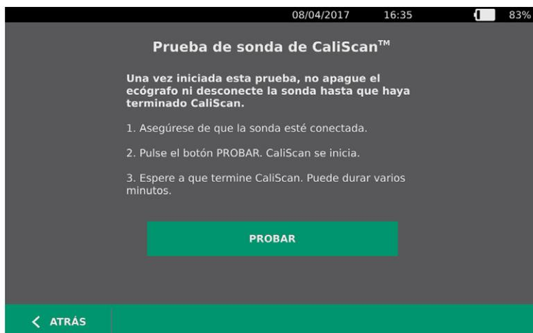
4. Si la sonda pasa la prueba, un mensaje en la consola indica que la sonda ha pasado la prueba. Cuando haya acabado de ver los resultados, toque **Atrás**.
