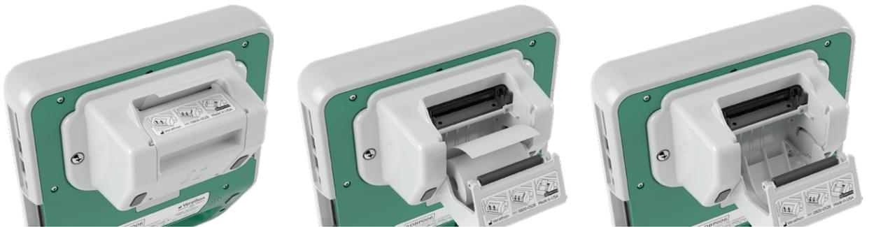
4. Utilice un algodón humedecido en alcohol isopropílico (IPA) para limpiar toda la longitud del cabezal de impresión. No utilice los dedos ni superficies duras o abrasivas para limpiar el cabezal de impresión.
