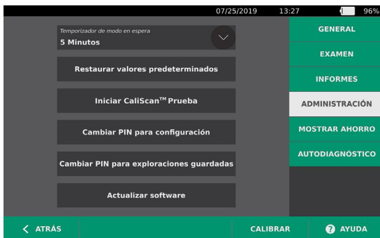
8. Cuando se le solicite, extraiga la batería y vuelva a insertarla. El sistema se reinicia y se completa la actualización del software.
