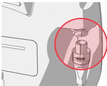
3. Inserire il connettore del cavo nella porta. Il cavo sarà collegato correttamente quando si udirà un "clic".
