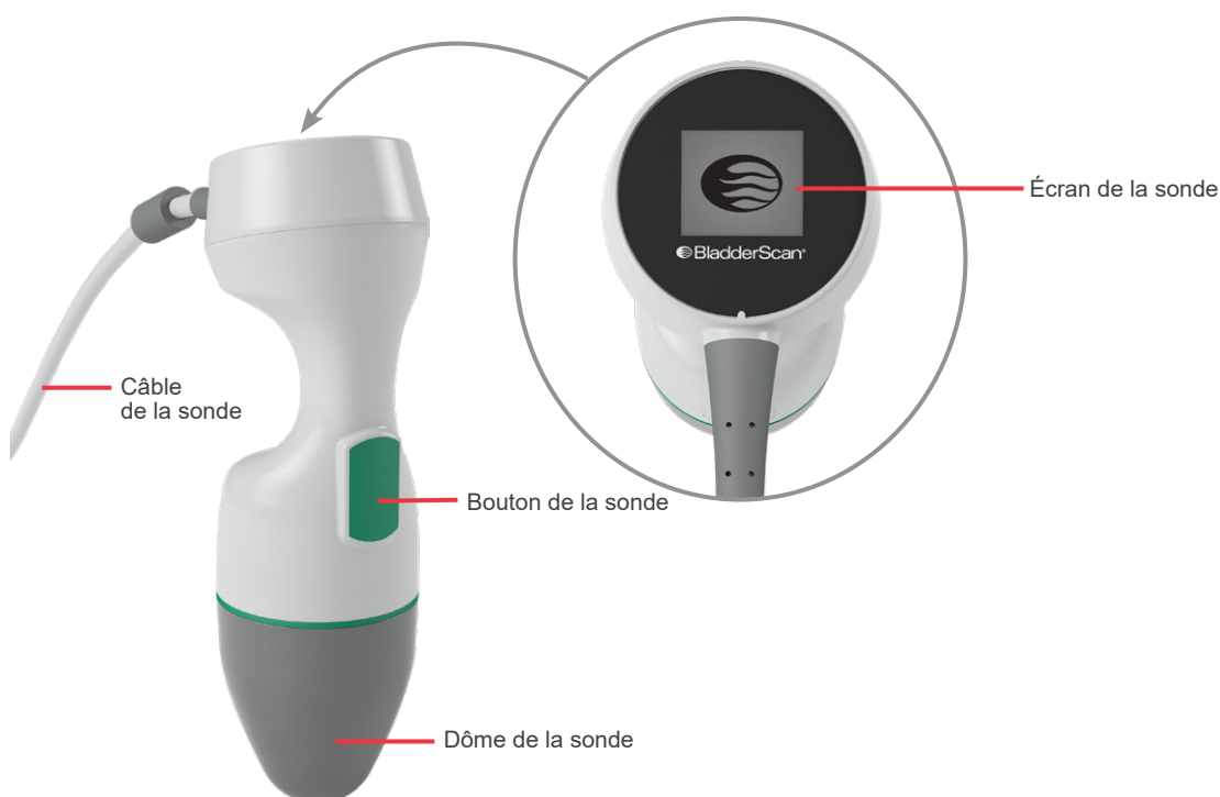
Figure 3. Caractéristiques de la sonde
