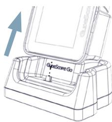
确保显示屏已从充电底座上取下，且断开了电源连接。
