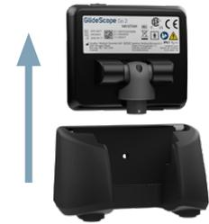
确保显示屏已从充电底座上取下，且断开了电源连接。
