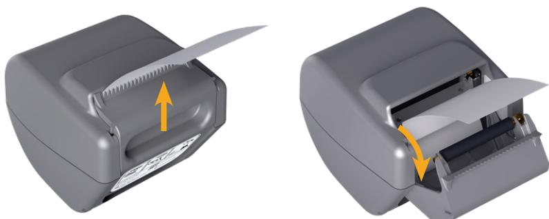
3. Tire con suavidad del papel para eliminar el atasco de papel. Si es necesario, tire de los trozos de papel doblado para sacarlos de la impresora y saque todos los trozos de papel que se hayan desgarrado del rodillo.
