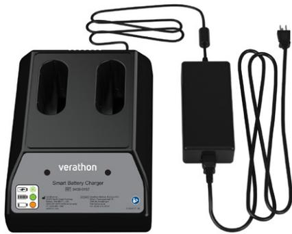
4. Enchufe el adaptador de alimentación a una toma de corriente de pared ordinaria. Asegúrese de que el cable de alimentación puede desconectarse fácilmente, en caso necesario.
