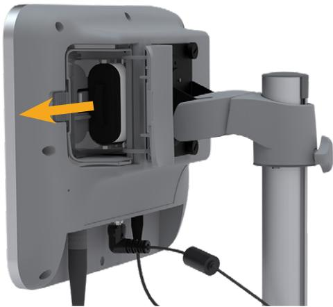
4. Deslice una batería cargada para introducirla en el compartimento de la batería con el logotipo de Verathon orientado hacia la parte posterior de la consola y presione ligeramente hasta que la batería quede completamente asentada.
