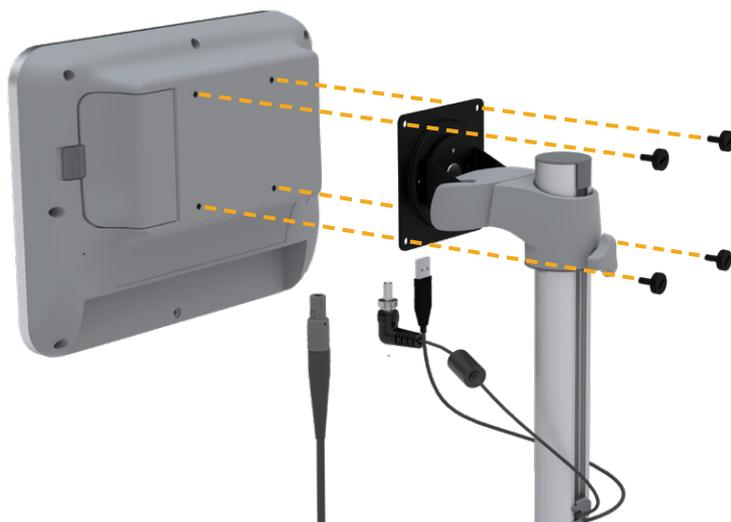
3. Conecte el cable de la sonda, el cable eléctrico, el cable de la impresora USB opcional y el cable del lector de códigos de barras opcional a la consola, tal como se muestra en la figura siguiente. Asegúrese de que el conector del cable eléctrico está colocado de forma segura y apriete manualmente su collarín de bloqueo con firmeza.
