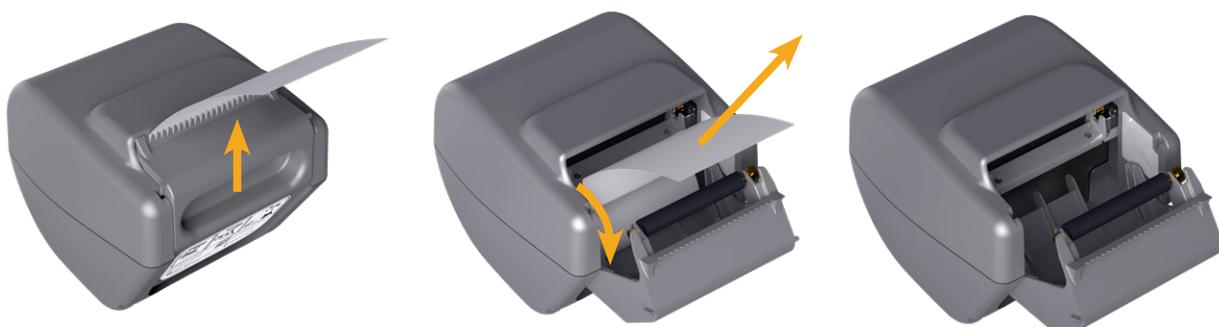
4. Utilice un algodón humedecido en alcohol isopropílico (IPA) para limpiar toda la longitud del cabezal de impresión. No utilice los dedos ni superficies duras o abrasivas para limpiar el cabezal de impresión.
