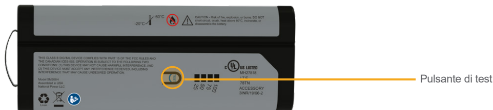
Figura 4. BladderScan i10 Batteria agli ioni di litio
