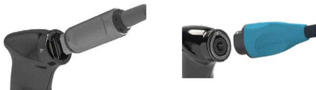
2. Para desconectar el endoscopio del cable de vídeo, sujete el conector del cable con una mano, el cuerpo del endoscopio con la otra y tire. El componente de vídeo se desconectará del cable.
