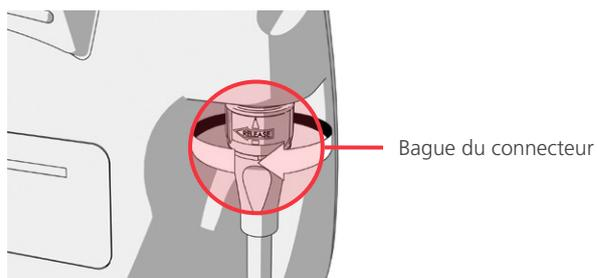
6. Pour déconnecter un vidéolaryngoscope du Smart Cable, tenez d'une main le connecteur de câble et de l'autre la poignée du vidéolaryngoscope, puis tirez. Le vidéolaryngoscope se déconnecte du câble.
