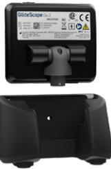
Veillez à **retirer le moniteur de la station de recharge** et à débrancher le boîtier d'alimentation.
