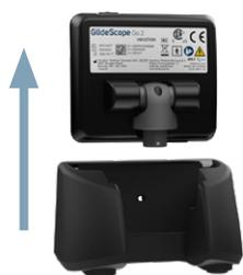
Certifique-se de que **o monitor foi removido da base de carga** e, em seguida, desligue a fonte de alimentação.
