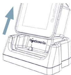
Certifique-se de que **o monitor foi removido da base de carga** e, em seguida, desligue a fonte de alimentação.
