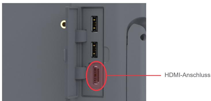
3. Schließen Sie das andere Ende des Kabels an die HDMI-Buchse des für medizinische Zwecke zugelassenen externen Monitors an.
