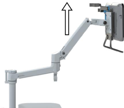
2. Drehen Sie mit einem 4-mm-Inbusschlüssel die Federeinstellschraube im Uhrzeigersinn, um die Hebekraft des Arms zu erhöhen, oder gegen den Uhrzeigersinn, um sie zu verringern. *Bei der optimalen Einstellung bleibt der Arm in Position, ohne sich von selbst abzusenken oder anzuheben.*
