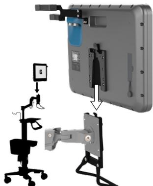
4. Um den Monitor zu entfernen, drücken Sie die Verriegelung nach unten, und heben Sie den Monitor von der Halterung ab.
